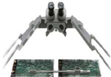
ภาพที่ 15 กล้องมองดูภาพถ่ายทางอากาศ (Mirror Stereoscope)
